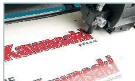
OPOS X, ist das zuverlässige optische System zum automatischen Konturenschneiden zum Produzieren von Aufklebern. Das optische System auf das man vertrauen kann.
