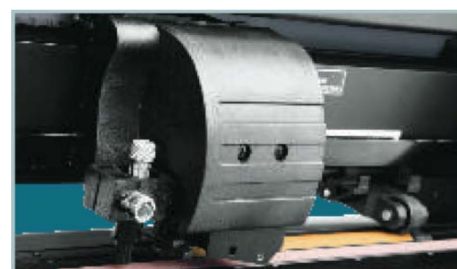
Ein neu konzipierter Hochgeschwindigkeits-Schneidekopf, für höchste Genauigkeit und überdurchschnittlicher Zuverlässigkeit, für ein müheloses Folienschneiden.
